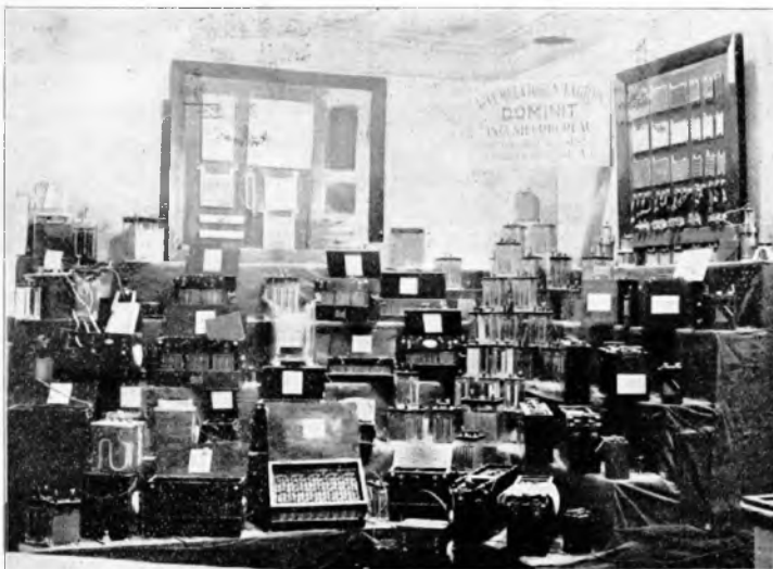
De stand van de Accumulatorenfabriek „Dominit” te Amsterdam. Onder de groote verscheidenheid van typen ziet men: links de „Niob-Tantal” gelijkrichter en midden een Anode-accu-batterij. Aan den wand eenige borden met diverse losse platen.
